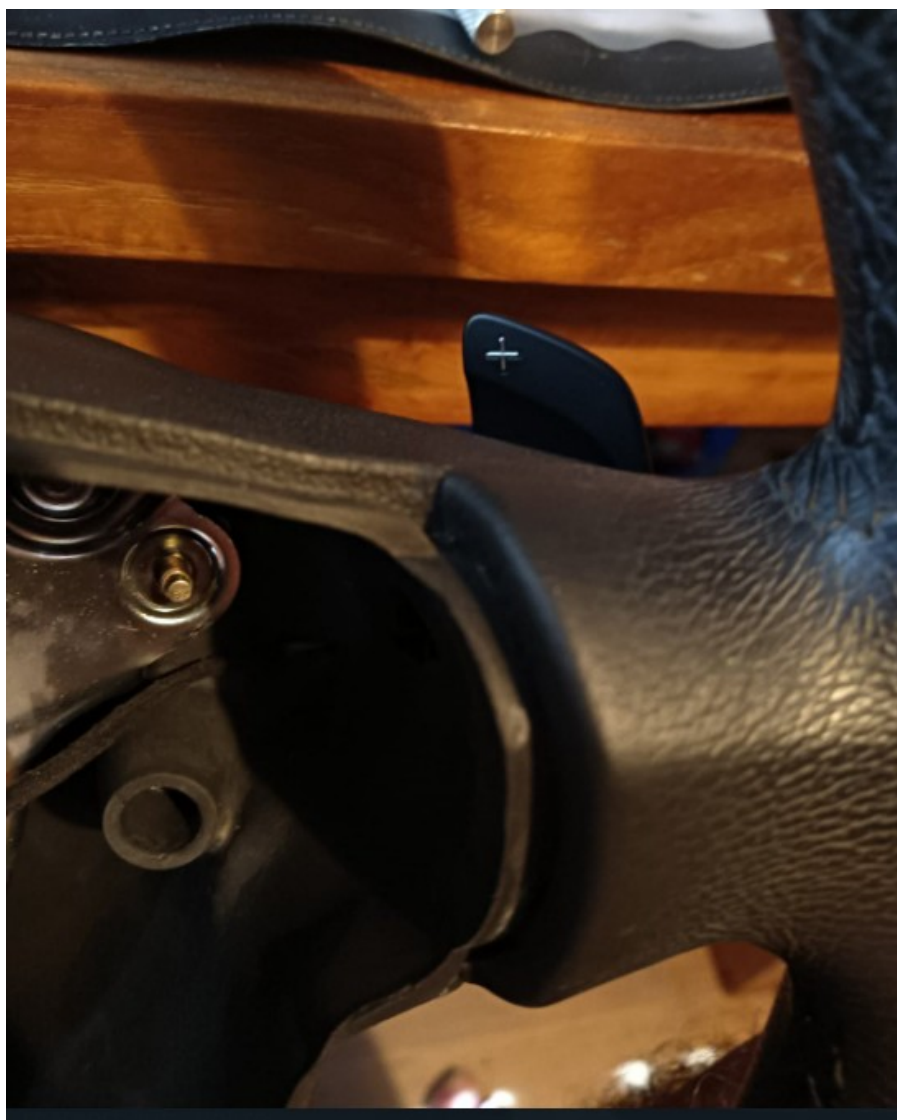
Bild 7 Schaltpaddel montiert / Picture 7 gearshift paddle mounted
