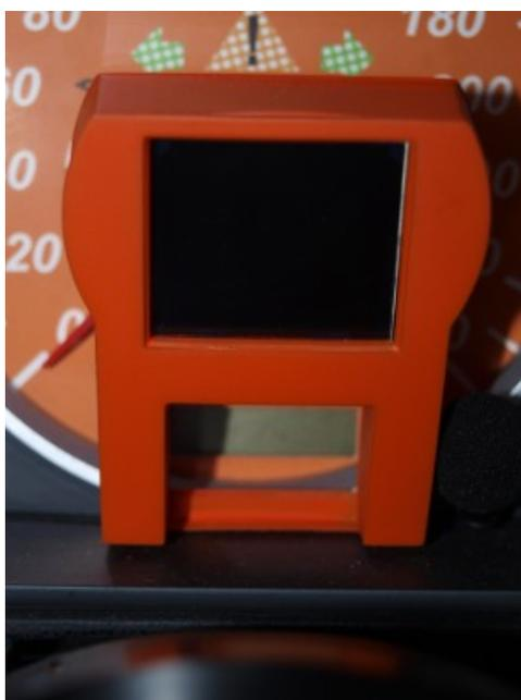
Der Tageskilometerzähler ist nach dem Einbau leider nicht mehr sichtbar. Die Bedienungseinheit wird auf dem Hebel für den Tempomat geschoben und das Kabel mittels zweier Kabelbinder befestigt,
